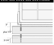
Placer un ruban à mesurer dans la partie arrière de la moulure de réception; mesurer jusqu'au haut de la face de la planche précédemment installée (au-delà de la bride de clouage). Transférer la mesure plus 1/4" sur la planche de revêtement, tirer le ruban du bas de la planche, marguer et couper.
